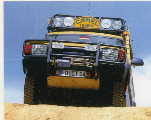
Gesichert: Ein stabiler Unterfahrschutz hält Felsbrocken fern, der Dachträger ist überaus massiv.
