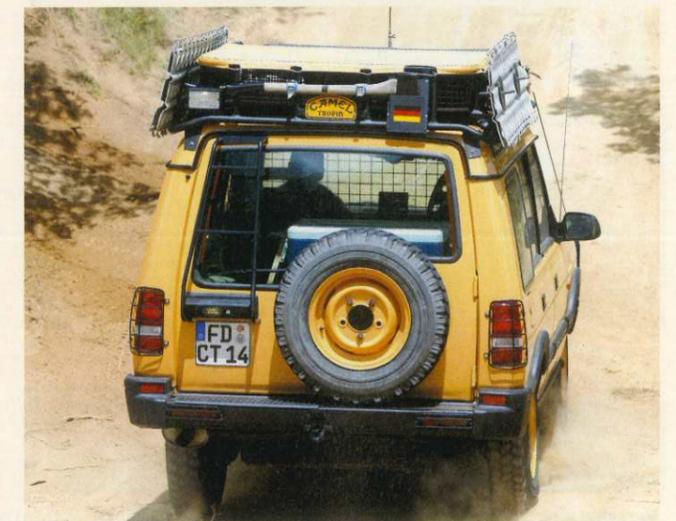
Erneuert: Die Holzplatten im Laderaum waren verrottet und wurden neu gefertigt, der Dachträger wurde originalgetreu nachgebaut.
