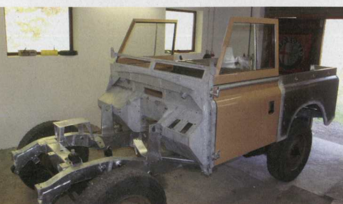
GRUND-STÜCK: Ein feuerverzinkter Rahmen aus Großbritannien.
