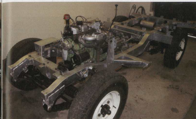
GRÖßENZUWACHS: Statt der originalen 6.00er sind größere 7.00er montiert.
