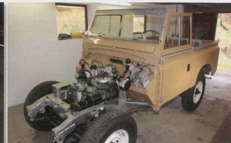
HOCHZEIT: Generalüberholter Motor im neuen Fahrgestell.
