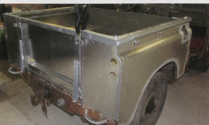
ORIGINALSTÜCK: Neue Seitenteile statt Alubleche des Defender 90.
