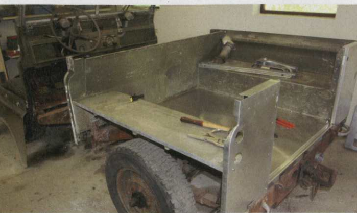
WERKSTÜCK: Die Heckwanne war komplett erneuerungsbedürftig.
