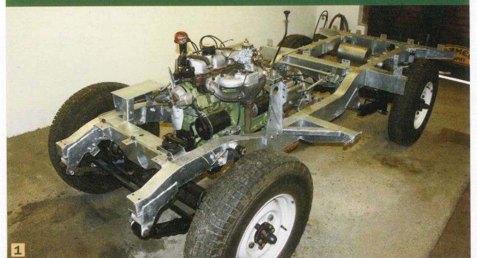
1 Grundgerüst der Komplettrestaurierung: ein feuerverzinkter Rahmen, den Sebastian in Großbritannien erstand. 2 Almost done: Original-Sitze in grauer „Elefantenhaut“ waren „leider nicht aufzutreiben.“ 3 Gammellock: Das Cockpit vor der Restaurierung.
